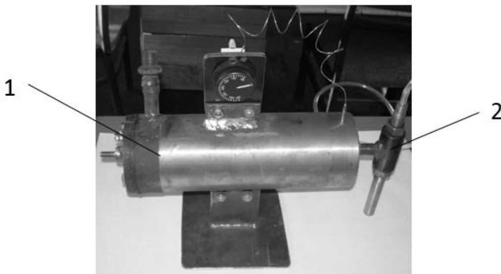
Рис. 1. Установка для газодинамічного нанесення функціональних покриттів: 1 – нагрівач повітря; 2 – напилувач порошку
